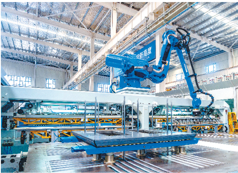
江苏华辰变压器股份有限公司内，自动剪叠机器人在作业。受访单位 供图
