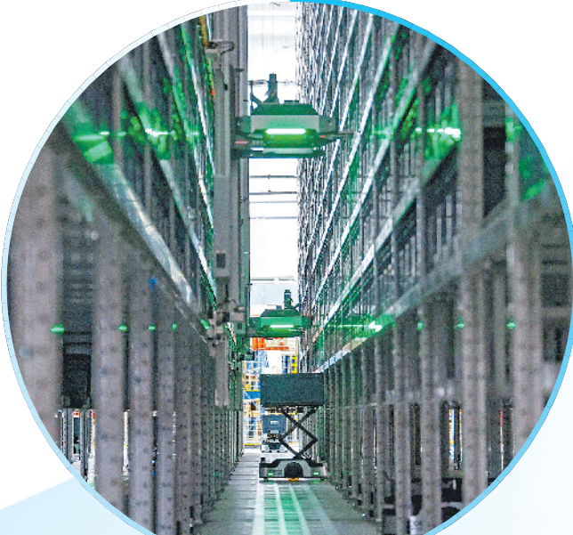
丰树智慧物流园京东物流智能仓内,飞梯机器人和搬运机器人来回穿梭。
