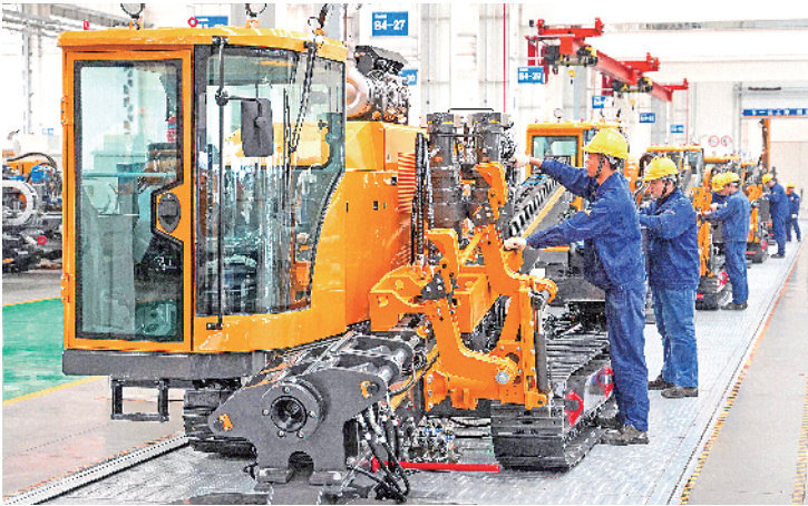
贾汪区青山泉镇徐工基础工程机械智能制造基地生产车间，工人正在组装小吨位水平定向钻机。
