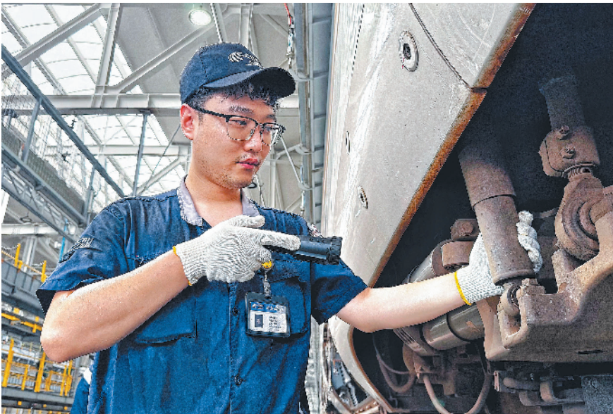
地勤机械师在检查列车裙边垂向减震器。 通讯员 徐玉恒 摄
