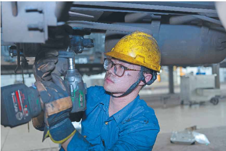
南京东车辆段徐州北检修车间工作人员在进行集尘器下体检修。通讯员 王楚元 摄
