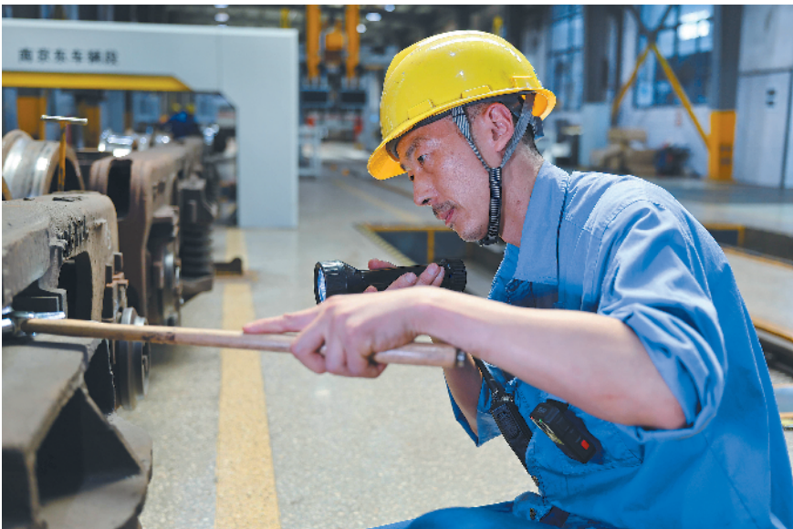
南京东车辆段徐州北检修车间工作人员在检查转向架交验。 通讯员 王楚元 摄
