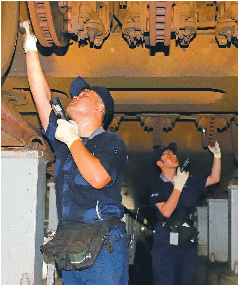
检修库内,地勤机械师正在对列车走行部进行检查。 本报记者 张荏衍 摄
