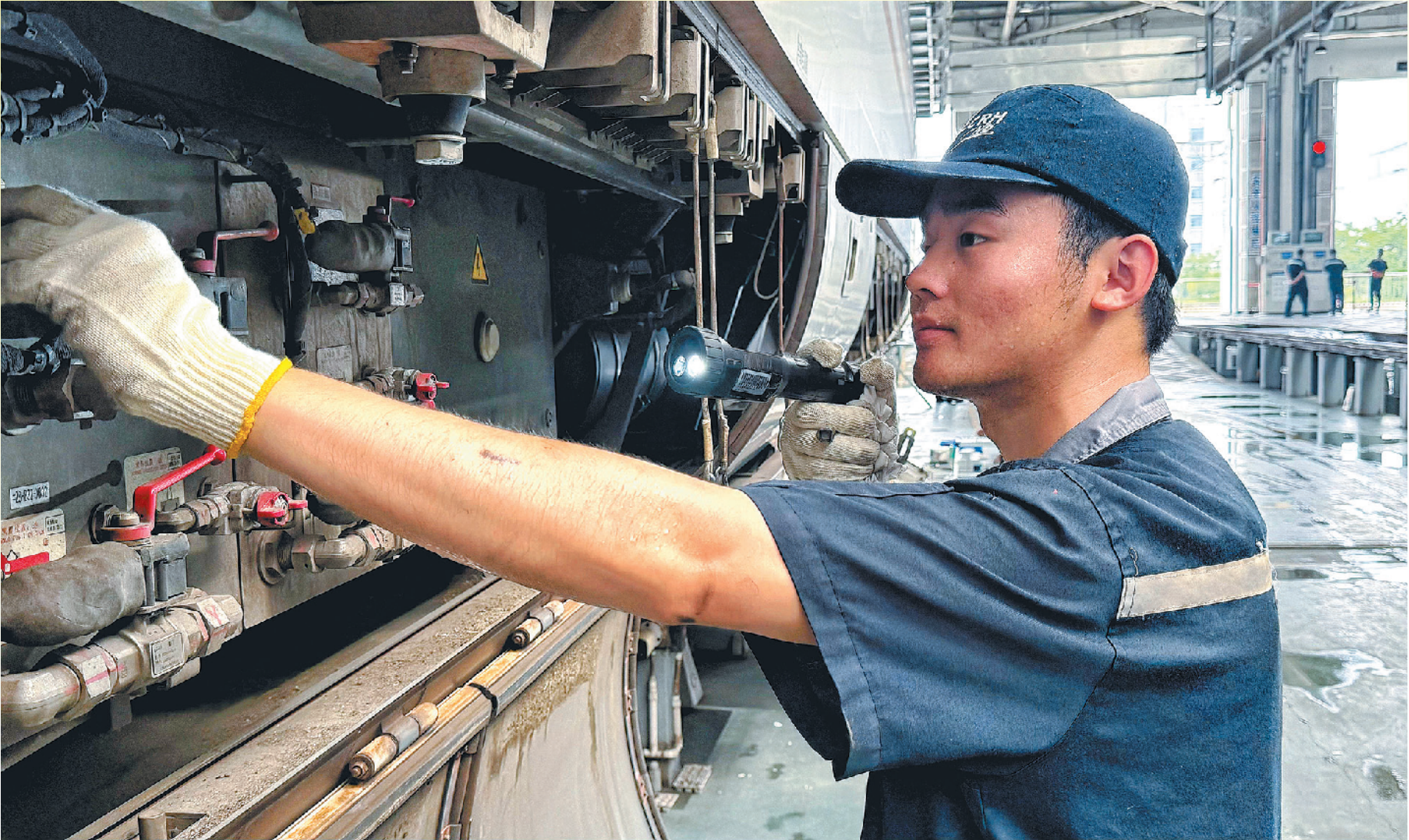
地勤机械师正在检查设备舱各类阀体件。 通讯员 徐玉恒 摄
