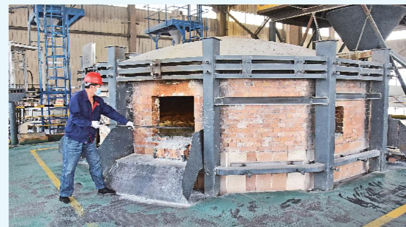
2 ▲在整个生产车间最高处，2023年投产的电窑炉正稳定运行，这是整个工厂的“心脏”，温度精准控制在1500℃以上，原材料在窑炉内充分熔化、排泡，形成纯净均匀的玻璃液。“以前用火焰炉又脏又难控温，现在电炉不仅环保，还能让玻璃液质量更稳定。”窑炉主任尹峰介绍道。
