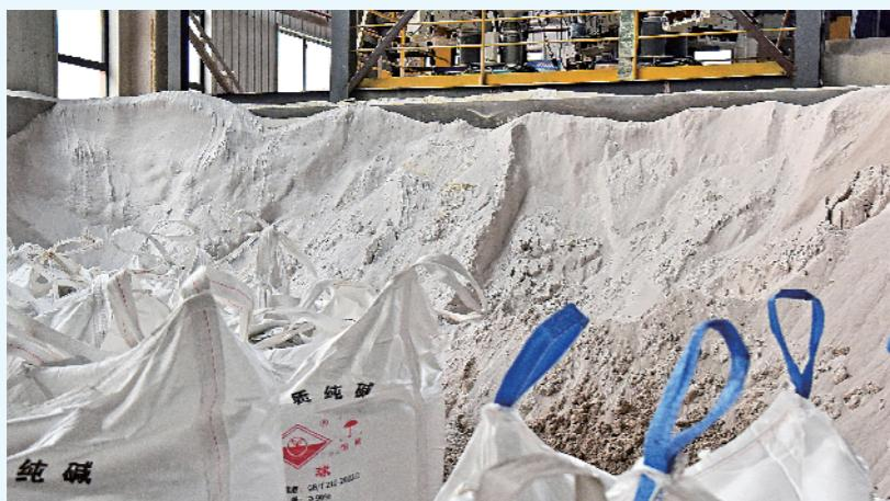
▲一个好的香水玻璃瓶，始于对原料的极致挑剔。车间原料区里，洁白的石英砂与纯碱整齐堆放。“普通玻璃瓶发绿发蓝，就是因为含铁量高。”工作人员表示，三和伟业专注于高端美妆玻璃容器的研发制造，选用低含铁量石英砂为核心原料，才能让玻璃瓶呈现出通透澄澈的质感。
