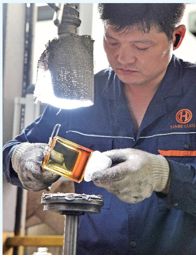
5 ▲退火后的瓶坯进入质检环节，这是产品出厂的第一道“关卡”。质检人员对每个瓶坯逐一细致排查，重点检测油污、气泡、划痕等潜在问题，不合格的产品会被分拣出来粉碎回收。不仅如此，瓶坯还要经过车间抽检，出厂前再按比例抽样复查，三重检验层层把关，织就严密的品质防线。
