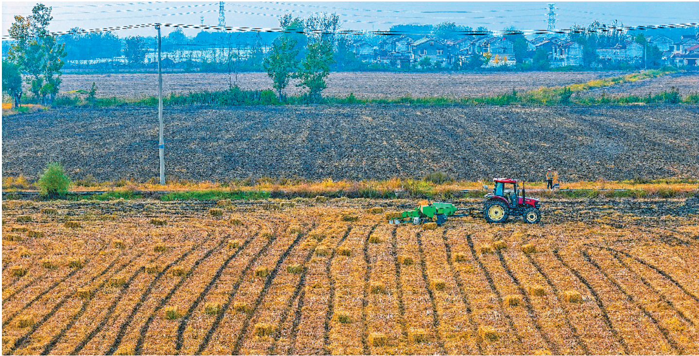
在郑集镇土楼村，秸秆打捆机将散落的秸秆压缩成一个个重约200公斤的圆柱形草捆。这些草捆随后被运往镇秸秆收储中心，经过分拣、粉碎后，一部分作为生物质发电原料供应给生物质热电厂，另一部分则加工成牛羊饲料，销往周边养殖场。
