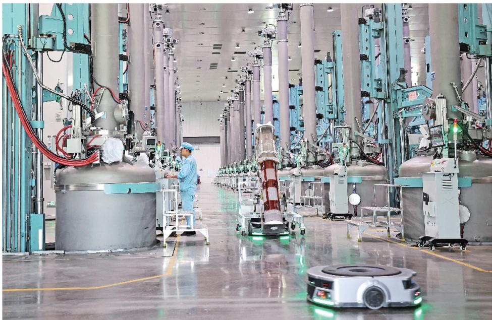
7月6日，江苏协鑫硅材料科技发展有限公司生产车间，AGV物流运输小车在运送生产材料。近年来，智能机器人、自动化生产线等智能设备在该公司的应用，大大提高了生产效率，降低了人力成本，实现了生产过程的智能化和精准化。
