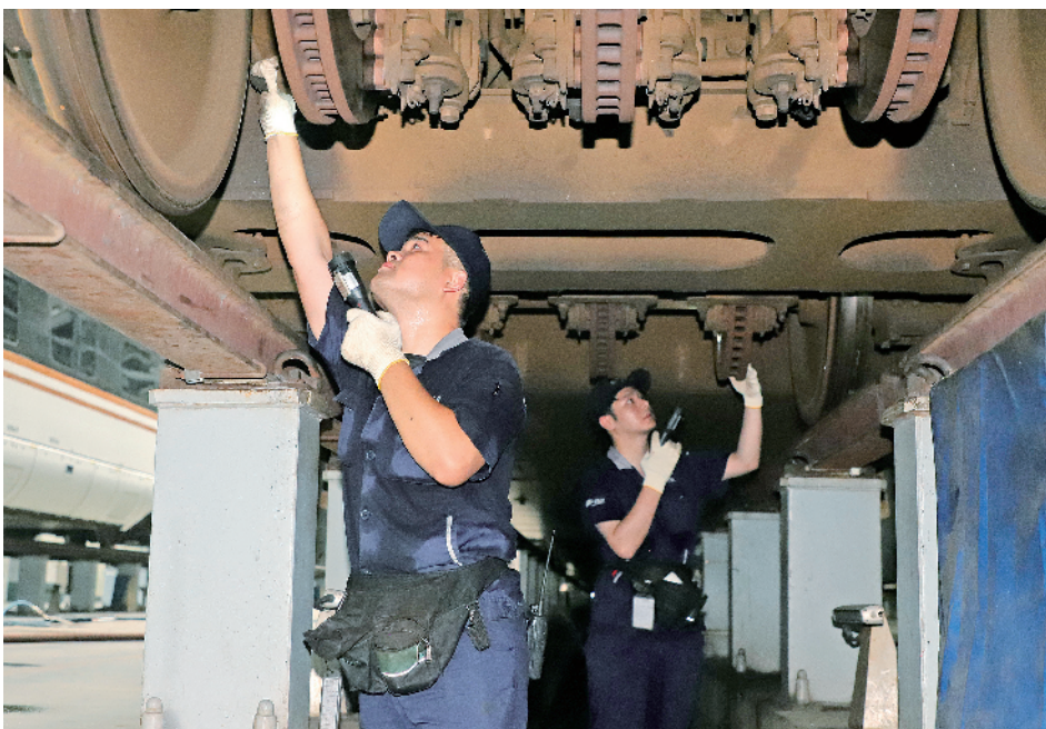
南京东车辆段徐州北检修车间工作人员在检查转向架交验。
