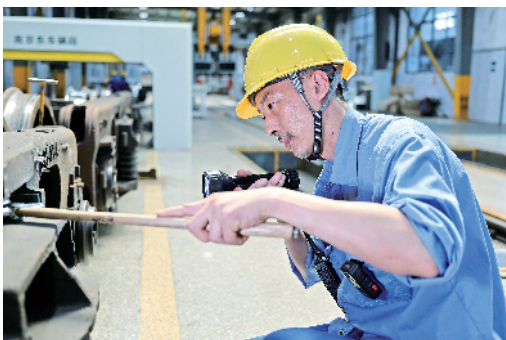
南京东车辆段徐州北检修车间工作人员在检查转向架交验。
