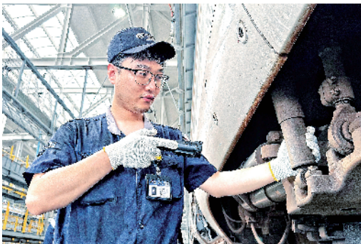
地勤机械师正在检查列车裙边垂向减震器。
