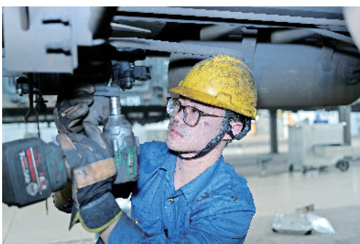
南京东车辆段徐州北检修车间工作人员正在进行集尘器下体检修。
