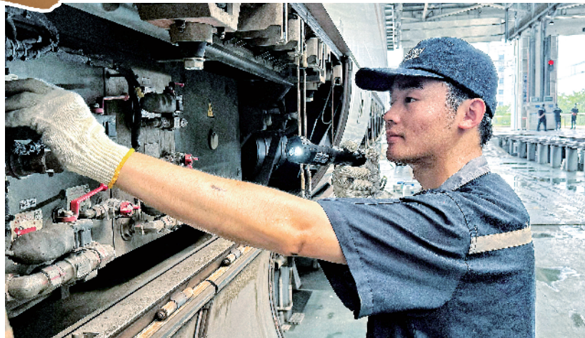
地勤机械师在检查设备舱各类阀件件。
