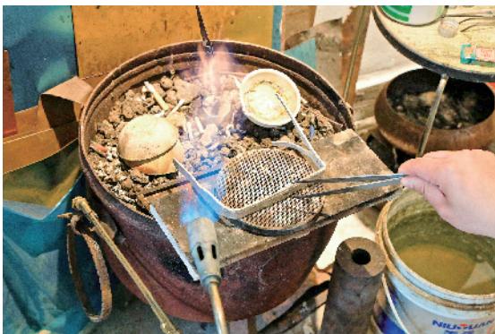
制作过程中进行退火,增加金属材料的延展性。
