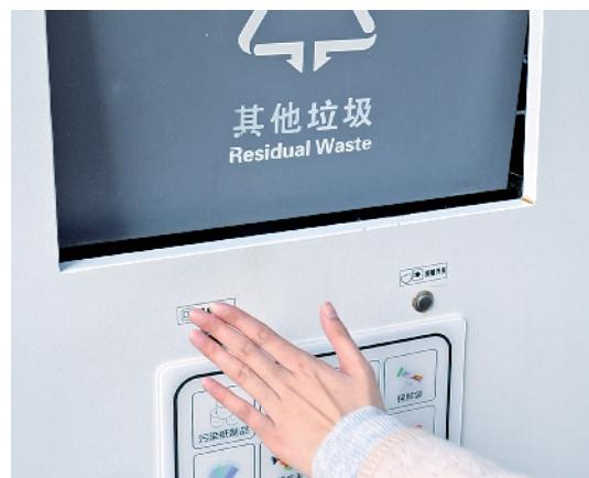
每个投口下方都有按键开关和感应开关。
