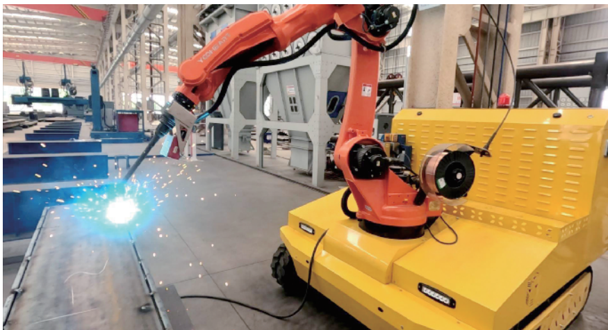
具身智能焊接机器人正在精准作业。
