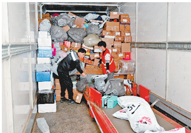
②卸货区里,伸缩皮带机直接对接货车车厢,工作人员将包裹迅速卸车。
